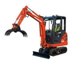
Мини-экскаваторы Everun особенно хорошо проявляют себя на небольших строительных площадках. Они отличаются экономичностью, интуитивно понятным управлением, а также отличным обзором и мобильностью, их легко транспортировать на объект. Машины оснащены системой вертикального копания (VDS), быстросъемным навесным с креплением easylock, могут оптимально работать при уклонах до 27°. Благодаря эргономичной посадке с круговым обзором управление становится точным и простым даже при длительной работе.
