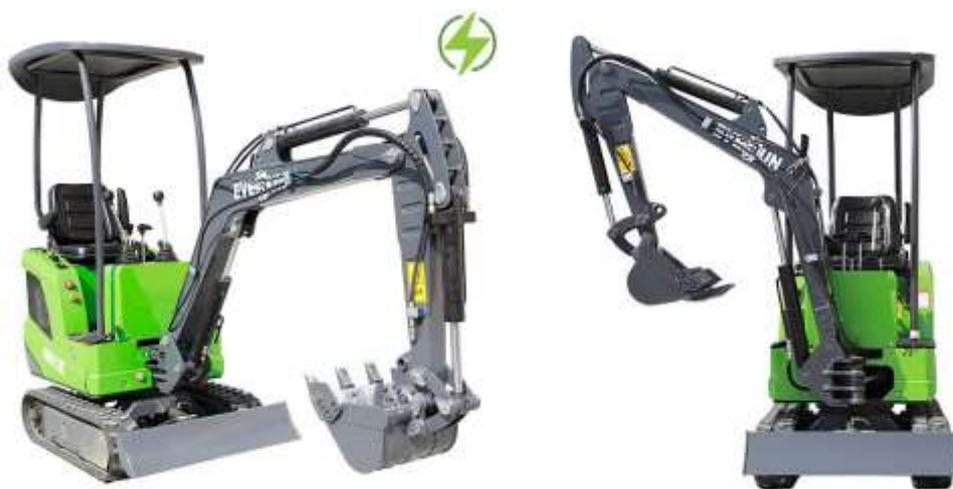
Мини-экскаваторы Everun особенно хорошо проявляют себя на небольших строительных площадках. Они отличаются экономичностью, интуитивно понятным управлением, а также отличным обзором и мобильностью, их легко транспортировать на объект. Машины оснащены системой вертикального копания (VDS), быстросъемным навесным с креплением easylock, могут оптимально работать при уклонах до 27°. Благодаря эргономичной посадке с круговым обзором управление становится точным и простым даже при длительной работе.
