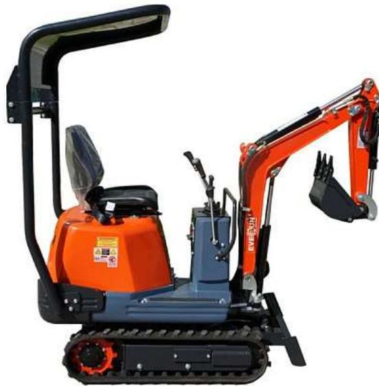
Мини-экскаваторы Everun особенно хорошо проявляют себя на небольших строительных площадках. Они отличаются экономичностью, интуитивно понятным управлением, а также отличным обзором и мобильностью, их легко транспортировать на объект. Машины оснащены системой вертикального копания (VDS), быстросъемным навесным с креплением easylock, могут оптимально работать при уклонах до 27°. Благодаря эргономичной посадке с круговым обзором управление становится точным и простым даже при длительной работе.
